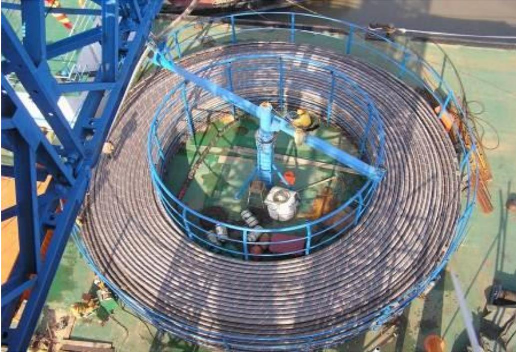
图 2.3-11 海缆散装过缆示意
