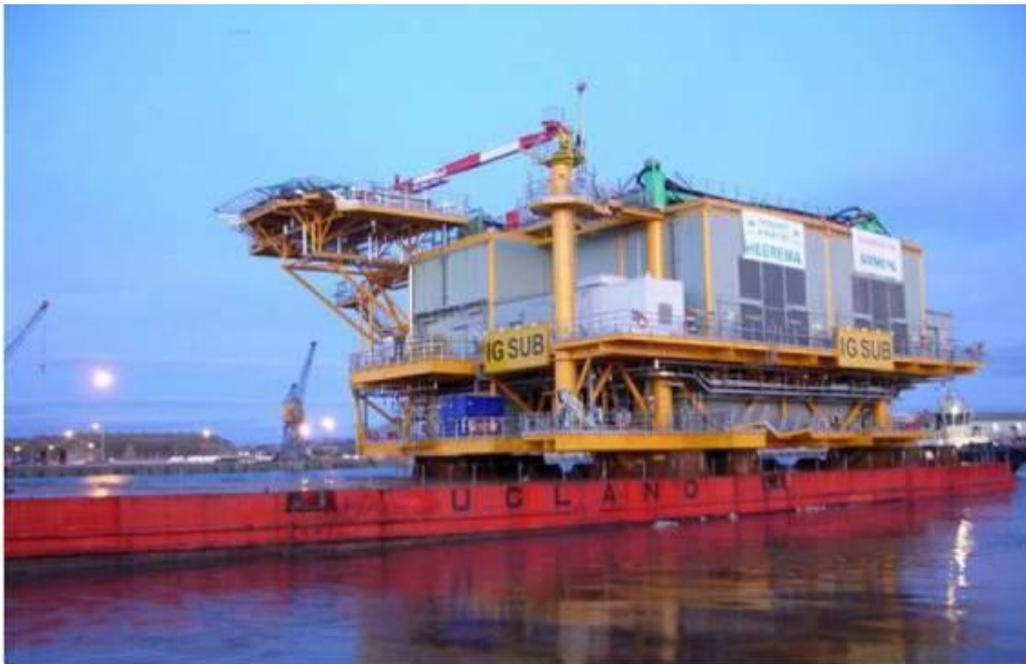
图 2.3-8 海上升压站整体运输示意图
