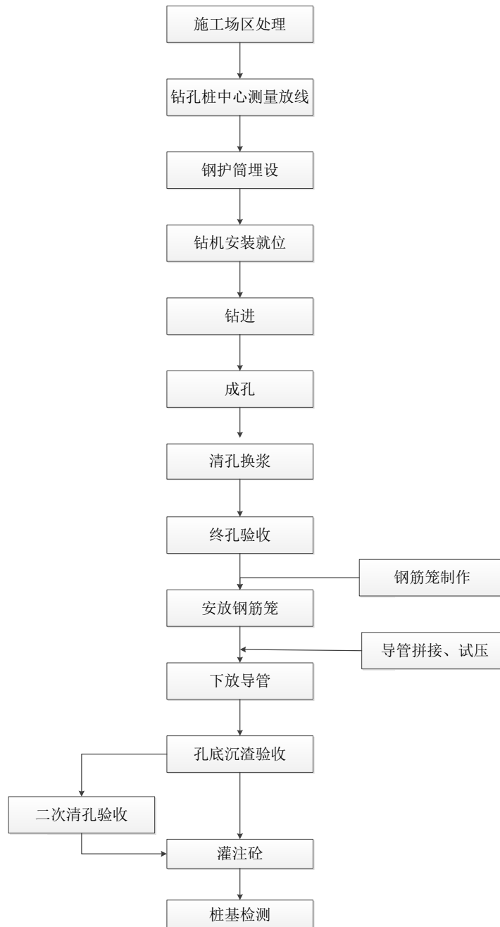
图1.7-4 灌注桩墩施工工艺流程图
