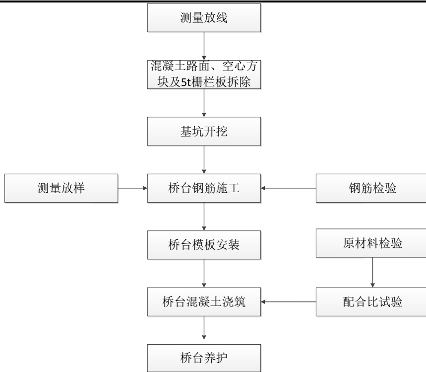
图1.7-5 桥台施工工艺流程图
