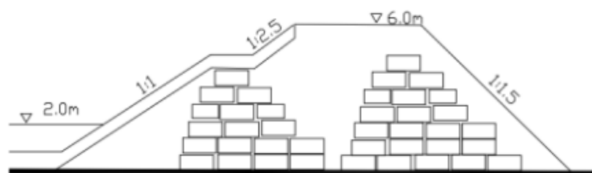
图 2.4-1 围堰断面构造示意图 (单位: 米, 1985 国家高程基准)
