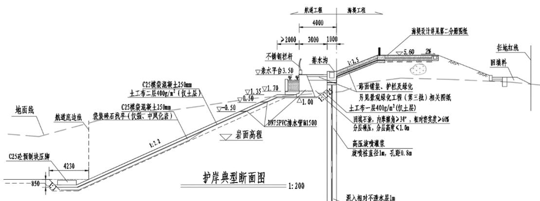
图 8.3-5 护岸断面图（型式一）
