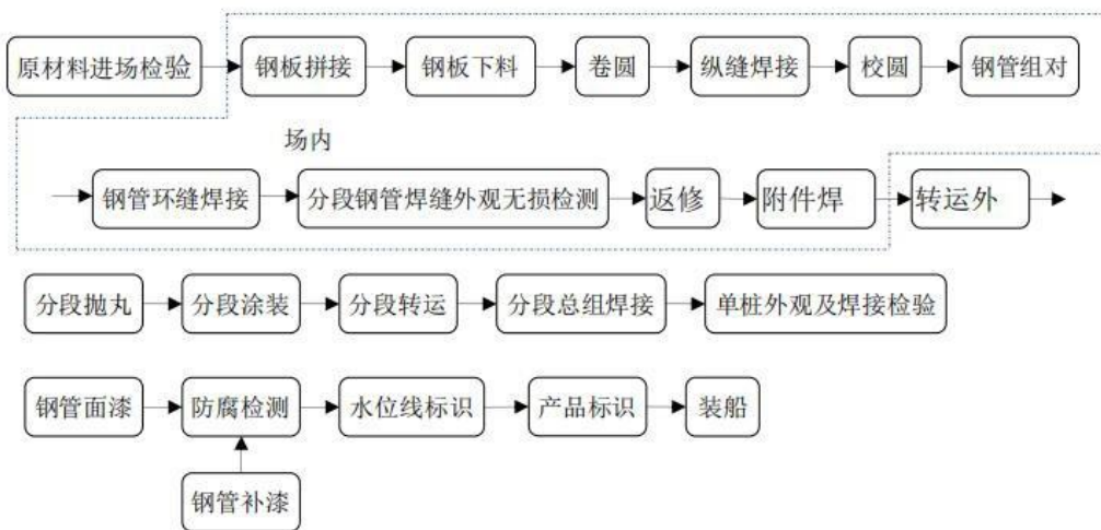
图 2.3.1-2 钢桩加工制作工艺流程图
