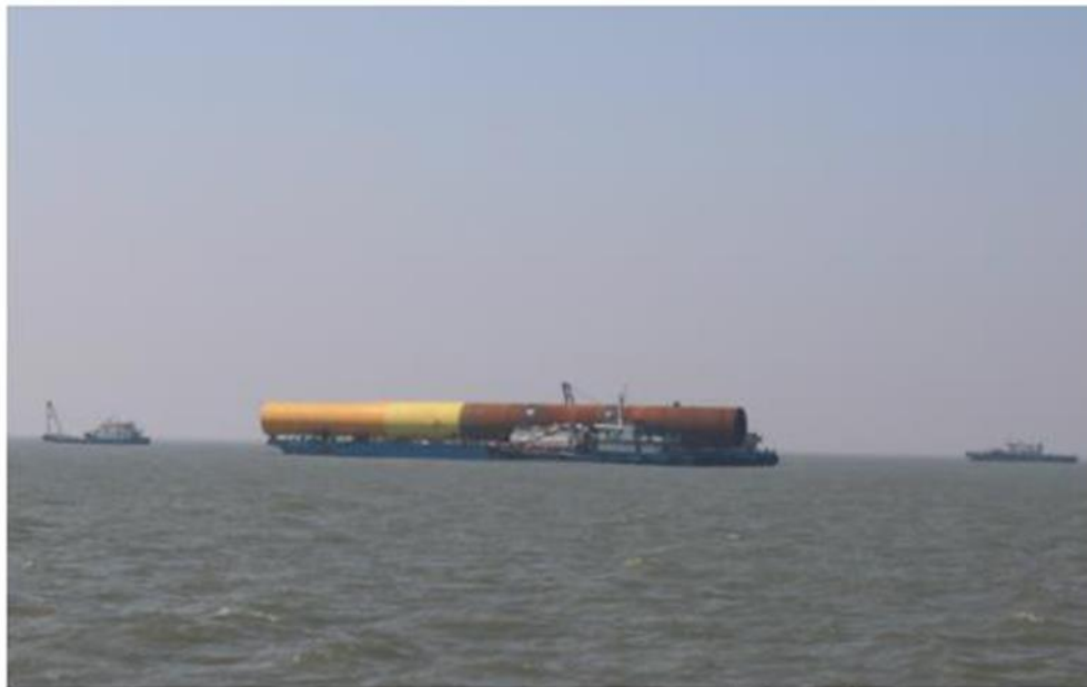
图 2.3.1-4 钢管桩运输示意图
