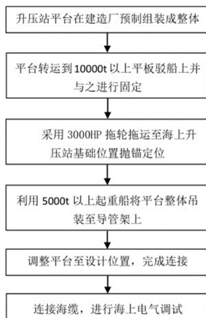
图 2.3.3-4 升压站平台整体安装流程图
