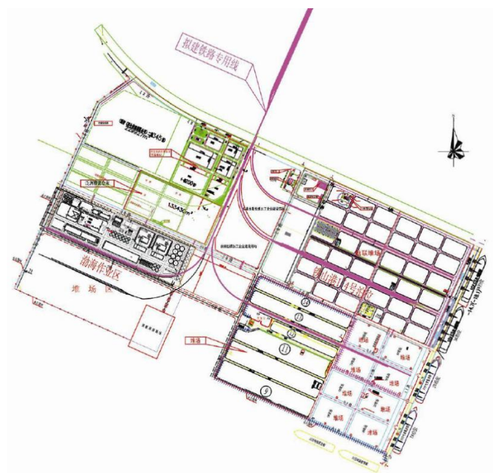
图 3.4-2 铁山港 1#~4#泊位和渤海粮油作业区总平布置
