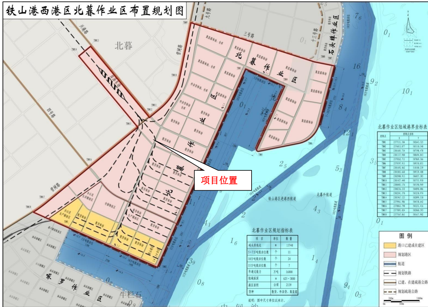
图 6.2-4 铁山港西港区北暮作业区布置规划图（北海港总体规划）
