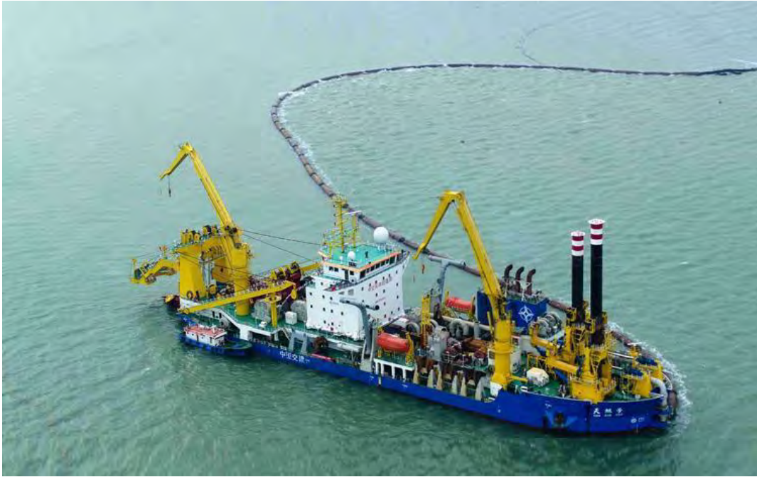
图2.3.3-5 绞吸船施工示意图
